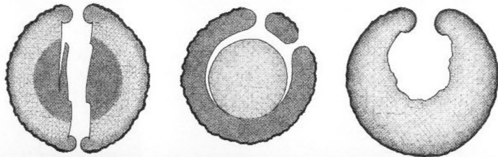
Fissure (ou gélivure) dans un chêne ; fissures (ou gélivures) associées à une roulure dans un châtaignier ; fente dans un hêtre. Coupes transversales
