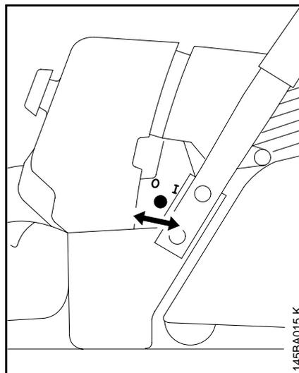
Pour allumer le chauffage électrique des poignées\*,
