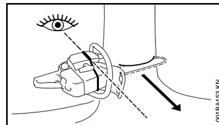
La nervure de visée prévue sur le capot et sur le carter de la tronçonneuse aide à contrôler la direction de chute lors du sciage de l'entaille d'abattage :
