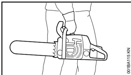
Toujours porter la machine à l'horizontale. Saisir la poignée avant de telle sorte que la machine soit bien équilibrée, à l'horizontale. La porter avec le silencieux chaud placé du côté opposé au corps et avec le dispositif de coupe en arrière.
