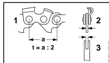
Sur cette tronçonneuse, on peut utiliser des chaînes avec différents pas – suivant le pignon monté (voir chapitre « Caractéristiques techniques ») :
