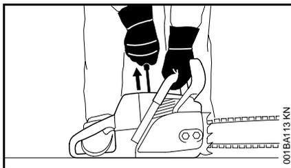
Avec la **première méthode** recommandée, on démarre la tronçonneuse au sol. S'assurer que le frein de chaîne est engagé (voir le chapitre « Frein de chaîne » dans la Notice d'emploi) et placer la tronçonneuse sur un sol ferme ou sur une autre surface solide, dans une zone dégagée. Prendre une position stable et sûre.
