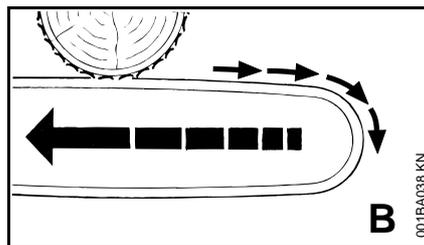
Un contrecoup peut se produire lorsque la section de chaîne située sur la partie supérieure du guide-chaîne est brusquement arrêtée parce qu'elle se coince, reste accrochée ou touche un corps étranger noyé dans le bois. La réaction de la chaîne repousse la tronçonneuse vers l'utilisateur qui risque de perdre le contrôle de la machine. Un contrecoup se produit souvent lorsqu'on coupe avec la partie supérieure du guide-chaîne.
