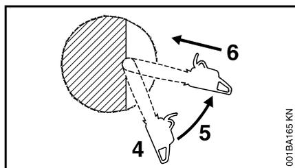
Le mortaisage se fait avec la tête du guide-chaîne. Commencer le mortaisage en appliquant la partie inférieure de la tête du guide-chaîne obliquement contre le tronc. Couper jusqu'à ce que la profondeur de l'entaille atteigne à peu près la largeur du guide-chaîne. Ensuite, aligner la tronçonneuse dans la direction dans laquelle le renforcement doit être coupé.
