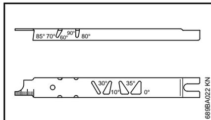
Utiliser le calibre d'affûtage STIHL (accessoire optionnel, voir le tableau « Outils d'affûtage ») – un outil universel pour contrôler l'angle d'affûtage, l'angle de front, le retrait du limiteur de profondeur, la longueur des dents et la profondeur de la rainure ainsi que pour nettoyer la rainure et les orifices d'entrée d'huile.
