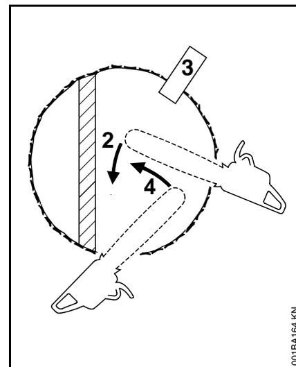
Éviter de repositionner la tronçonneuse plus souvent que nécessaire. En passant à la coupe suivante, le guide-chaîne doit toujours rester entièrement dans l'entaille de coupe, pour garantir que la coupe d'abattage soit bien droite. Si la tronçonneuse commence à se coincer, introduire un coin pour ouvrir l'entaille de coupe. À la dernière coupe, veiller à ne pas attaquer la charnière.
