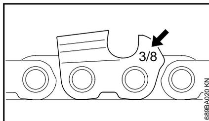
La cote du pas de chaîne (p. ex.  $\frac{3}{8}$ " ) est estampée sur chaque dent de coupe, dans la zone du limiteur de profondeur.
