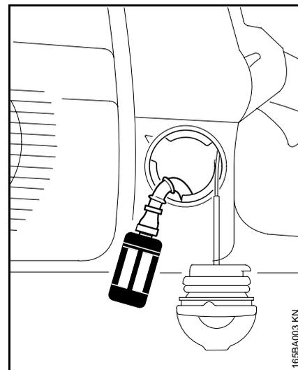
**Remplacer la crépine d'aspiration de carburant une fois par an.**
