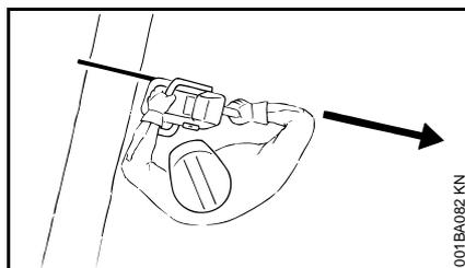
Lorsque le moteur est en marche, toujours tenir la tronçonneuse de telle sorte qu'aucune partie du corps de l'utilisateur ne se trouve dans le rayon d'action du dispositif de coupe. Au tronçonnage, se tenir du côté gauche par rapport au plan de coupe.
