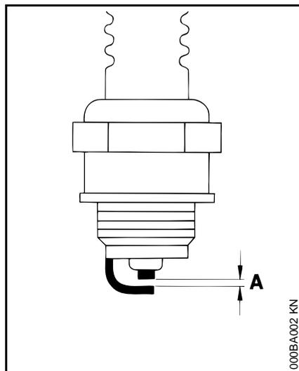
Un mélange de carburant incorrect (trop grand pourcentage d'huile moteur dans l'essence), un filtre à air colmaté et des conditions de fonctionnement défavorables (lorsque la machine est principalement utilisée avec commande d'accélérateur à mi-course etc.) ont une influence défavorable sur l'état de la bougie. Ces facteurs entraînent la formation de dépôts sur l'extrémité de l'isolateur, ce qui provoque des perturbations du fonctionnement.
